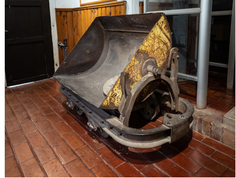
Figura 8. Carro minero de volteo, utilizado en la mina El Cacique hasta 1970. Exposición permanente en el Museo Padre Gerardo Alkemade de Alhué.
